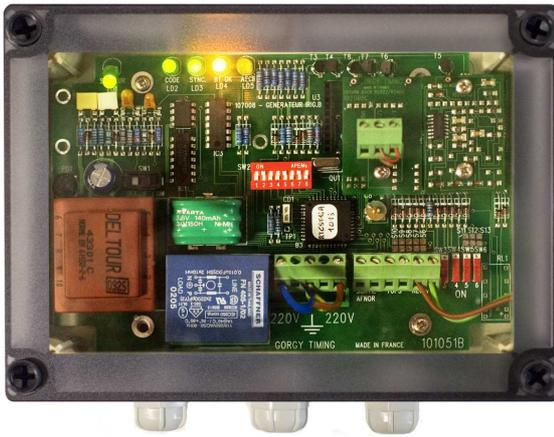
Die RT93 ist ein Zeitgenerator, der von einer externen Zeitquelle synchronisiert wird. Er sendet eine hochpräzise gesicherte Zeit an Nebenuhren, Hauptuhren oder Computer-Anlagen.
